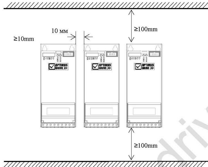
Примечание: Если площадь не позволяет выделить необходимые монтажные зазоры, необходимо обеспечить принудительную вентиляцию.
